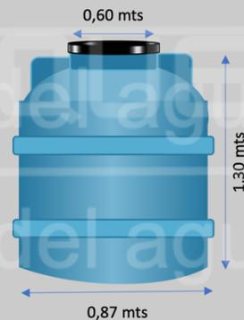
**NOTA:** Considere en las medidas de altura y diámetro una tolerancia +- 5%. En la capacidad volumétrica considere una tolerancia +- 5%.
