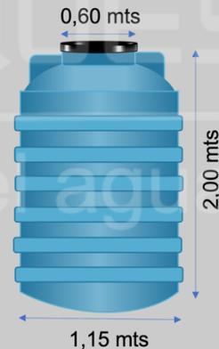
**NOTA:** Considere en las medidas de altura y diámetro una tolerancia +- 5%. En la capacidad volumétrica considere una tolerancia +- 5%.
